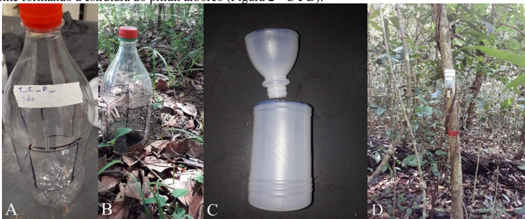
Figura 2- A: Pitfall do tipo Trampa Provid com altura e tamanho das janelas adaptados para a coleta de formigas forrageadora de solo, B: Pitfall instalado no solo na CEPLAC, C: confecção do modelo de pitfall arbóreo usado na pesquisa, D: pitfall arbóreo instalado na vegetação da CEPLAC, Alta Floresta-MT, Brasil. (Fonte: O autor).
