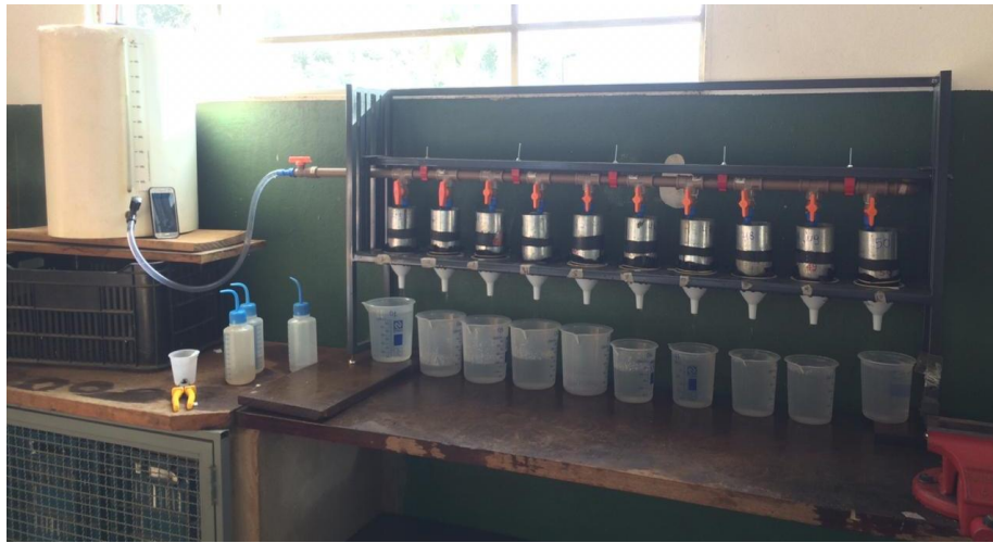
Figura 2 – Amostras de solo em avaliação no permeômetro de carga constante. (Fonte: O autor).
